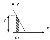
L'élément de surface choisi est : ds=y dx avec  $y = -\frac{b}{a}x + b$
