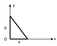
Le volume engendré en faisant tourner la plaque autour des axes Ox et Oy est égal au produit de la surface de la plaque par la longueur du cercle décrit par son centre de masse. En tournant autour de Ox, la plaque engendre un cône de hauteur a et de rayon de base b, son volume est :  $V=\frac{\pi b^2 a}{3}$  Son centre de masse décrit un cercle de rayon y<sub>G</sub> centré sur Ox De longueur L= $2\pi y_G$
