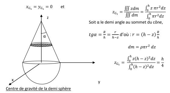
L'élément de volume choisi, est un disque d'épaisseur dz, d'axe Oz et de rayon r, se trouvant à la distance z du centre O de la demi sphère, d'où : $R^2=z^2+r^2\to r^2=R^2-z^2$
