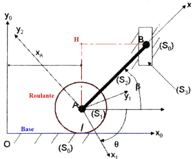
$$7) \vec{\gamma}(B \in S_2 / S_0) = \vec{\gamma}(B \in S_3 / S_0) = \frac{d\vec{V}(B \in S_3 / S_0)}{dt} /_{R_0}$$
