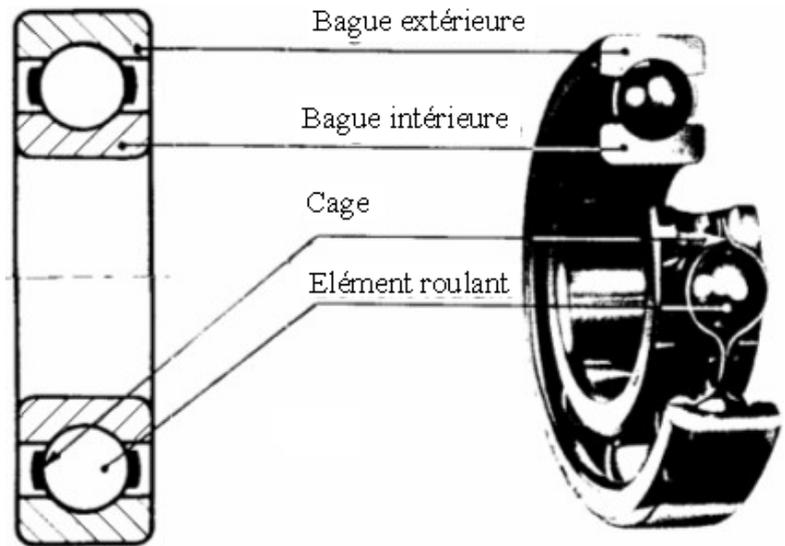
Figure 1 Représentation schématique du roulement à billes
